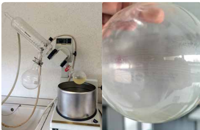
RYS. 8 Odparowywanie rozpuszczalnika przy użyciu parownika obrotowego (po lewej) Proszek na ściance kolby po odparowaniu rozpuszczalnika
