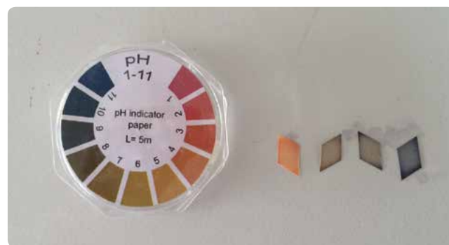
RYS. 2 Sprawdzenie zasadowości papierkiem wskaźnikowym
