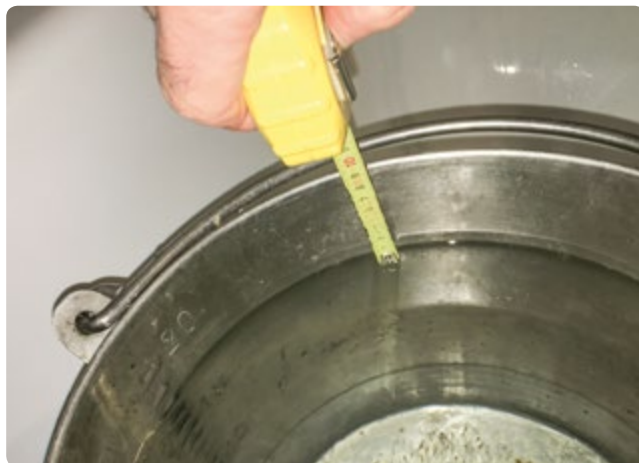
FIG. 2 Mesure du niveau d'eau pour obtenir le volume d'eau
