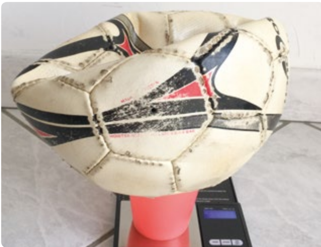
FIG. 4 Mesure de la masse du ballon vide d'air
