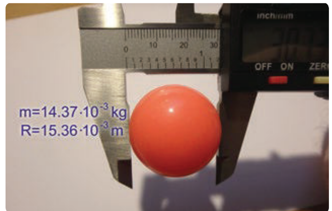
РИС. 9. \omega = 156 \text{ s}^{-1} , E_{kin,tr(1)} = 2.46 \cdot 10^{-2} \text{ J} , E_{kin,tr(2)} = 4.14 \cdot 10^{-2} \text{ J}
