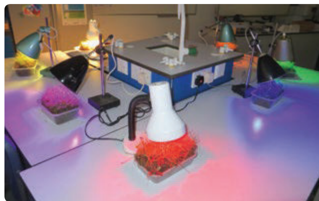
РИС. 9. Лотки с травой освещались различными цветными лампами в течение шести дней перед сбором травы для измерения свежей массы в качестве индикатора скорости роста.
