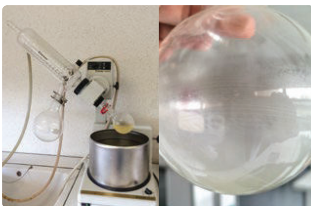
Рис. 8. Испарение растворителя с использованием ротационного испарителя (слева). Порошок на боковой поверхности колбы после испарения растворителя.
